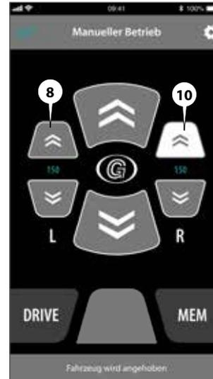
1. Halten Sie die Taste (10) gedrückt. Die Luftfeder hebt rechts an bis die Taste losgelassen wird.
