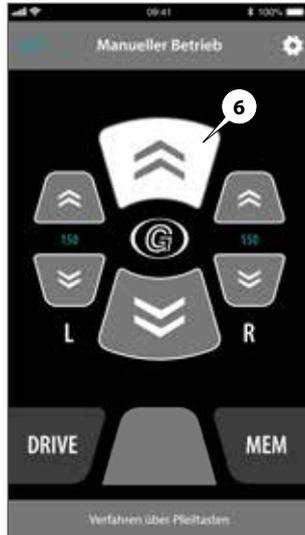
1. Halten Sie die Taste (6) gedrückt. Die Luftfeder hebt an bis die Taste losgelassen wird.
